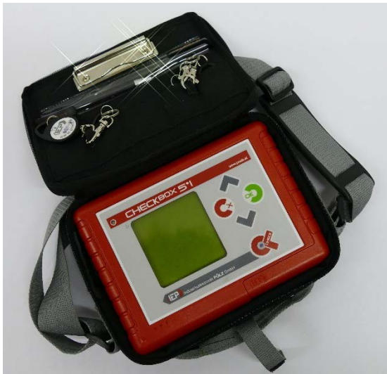
Atmenschutzüberwachung elektronisch mit Transpondererfassung und Dokumentation Verein
